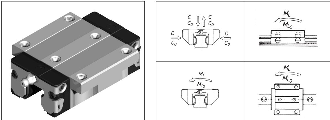
Bei Vergleich mit der häufig zugrundegelegten Lebensdauer von 50.000 m Hubweg sind die Tabellenwerte für  $C$ ,  $M_t$  und  $M_L$  mit 1,26 zu multiplizieren.
