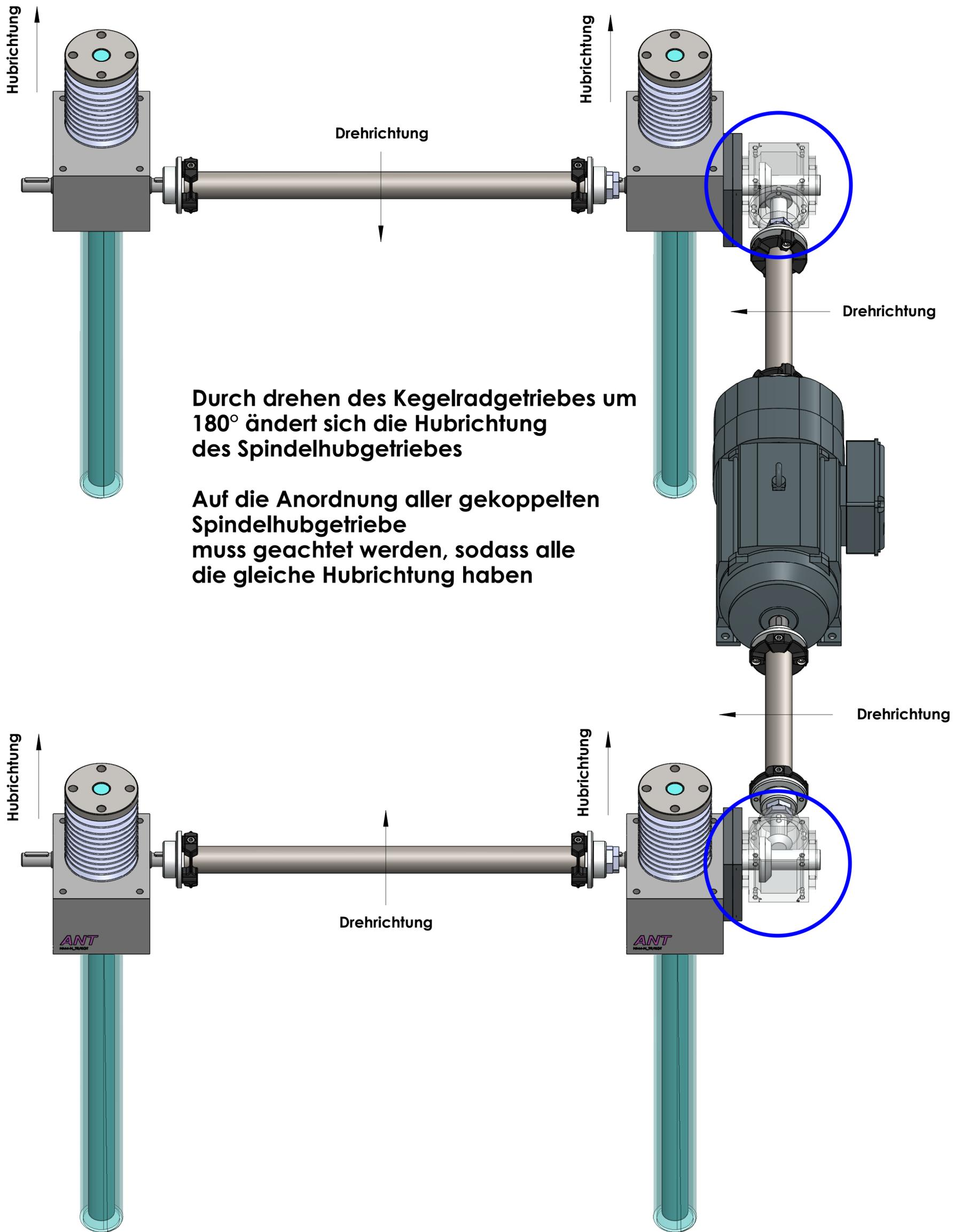
Durch drehen des Kegelradgetriebes um 180° ändert sich die Hubrichtung des Spindelhubgetriebes
